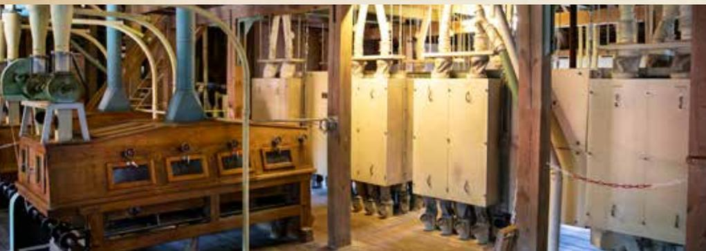
Die dabei unterschiedlich entstandenen Bruchstücke des Getreides werden durch Sieben im Plansichter getrennt. Der Plansichter ist ein schrankähnlicher, hin und her schwingender Kasten. Darin befinden sich, übereinander gestapelt, viele unterschiedliche Siebe.
