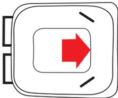
Nur Behälter, die so positioniert sind, können über den Greifarm aufgenommen werden. Ist dies nicht der Fall, muss der Fahrer das Fahrzeug abstellen, aussteigen und den Behälter zurecht rücken. Dies führt zu erheblichen Verzögerungen bei der Entleerung und Wartezeiten für den Verkehr.
